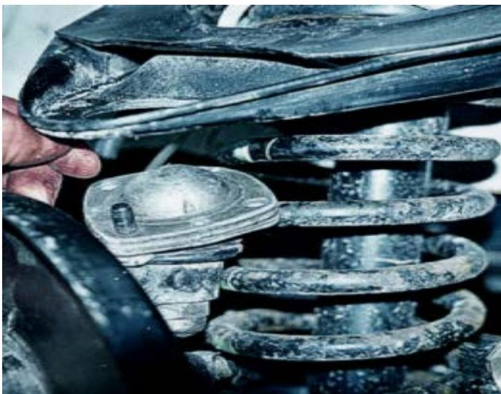
Собранный таким образом резинометаллический шарнир сайлентблоком уже не является. У него значительно снижена несущая способность, и при нагрузке намного меньше номинальной он может перейти в режим работы простой резиновой втулки. В результате этого его посадочное место в рычаге изменит геометрию и будет непригодно к дальнейшей эксплуатации.
