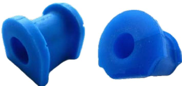
Основная задача втулок – это понижение шумности подвески при движении и крепление стабилизатора к кузову автомобиля. Как правило, они производятся из двух материалов: полиуретан и резина. Детали обладают высокой упругостью и прочностью, из-за чего скрипы и стуки при изменении высоты какого-либо из колес отсутствуют. К тому же прикрепить стабилизатор к кузову жестко невозможно, поскольку расстояние от места крепления к краю стабилизатора при изгибе меняется.
